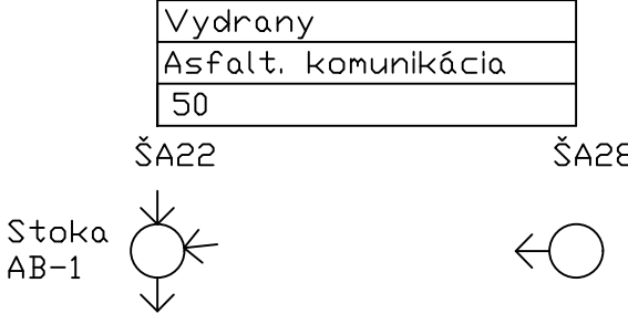
KANALIZAČNÁ STOKA "AB-1-1" PVC DN315 dĺžka 50 m
